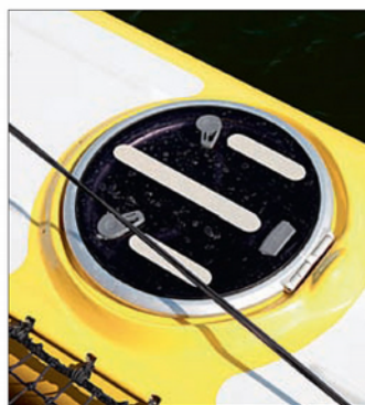
◀ Sur les flotteurs, les panneaux ouvrants sont équipés d'un carénage afin de limiter les éventuelles entrées d'eau. Ce même type de carénage est utilisé sur le panneau avant de la coque centrale.
