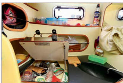
▲ Le coin cuisine et son réchaud fixé sur une planchette pivotante permettant d'accéder aux en-cas.
