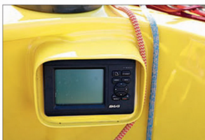
▲ Pour améliorer la visibilité des cadrans du cockpit, chacun est ceinturé d'un entourage faisant office de casquette.
