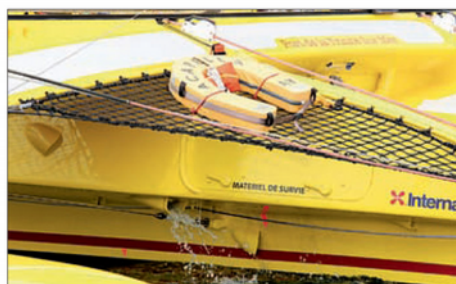
▲ Le coffre de survie intégré à la jupe sur bâbord est aussi accessible depuis l'extérieur en cas de chavirage.
