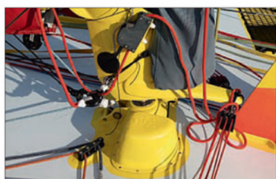
▲ Equipé d'un mât aile pivotant en carbone, A Capella dispose au niveau du pont d'un petit boîtier protégeant la transmission de la girouette électronique.
