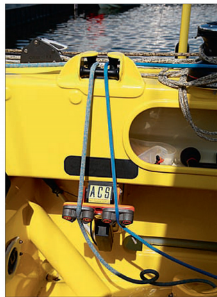
▲ Sur le bras arrière, le « déviateur » permet de faire circuler toutes les écoutes (GV, génois, gennaker) avant qu'elles n'arrivent aux taquets du système anti-chavirage qui libère automatiquement le cordage en cas de surtension.
