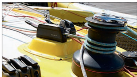
▲ Pour aligner les manœuvres courantes au winch et éviter ainsi le surpattage, les bloqueurs sont rehaussés à l'aide d'une boîte en stratifié.
