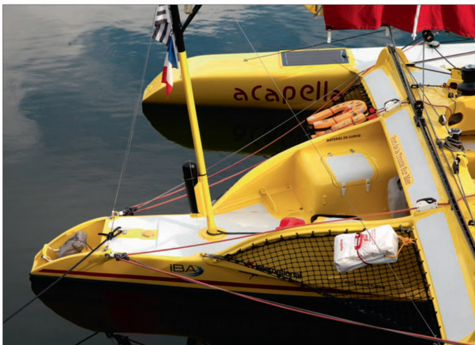
▲ Sur l'arrière de la coque centrale, pas de tubes en alu comme sur Happy , mais une très grande jupe où l'on remarque sur bâbord le coffre à survie.
