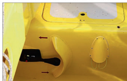
▲ Dans le cockpit, la protection de la commande moteur (obligatoire) ainsi que celle du pilote de secours.
